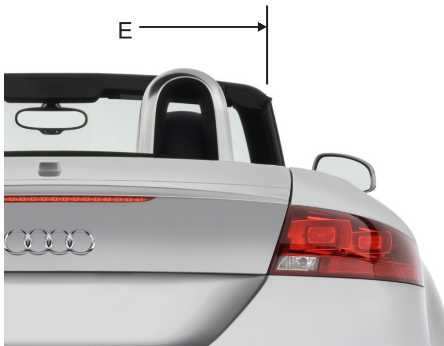
Figure 26 – Mesure de la largeur de toit (décapotables)
