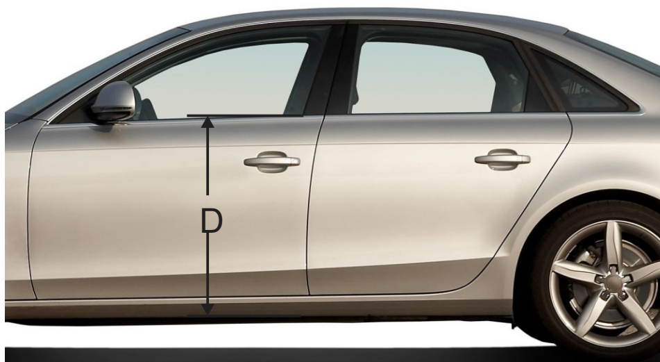
Figure 21 – Mesure de la hauteur latérale de la carrosserie
