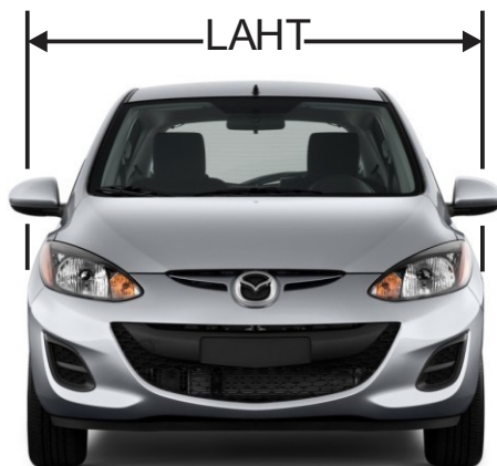
Figure 8 – La largeur hors tout exclut les rétroviseurs extérieurs
