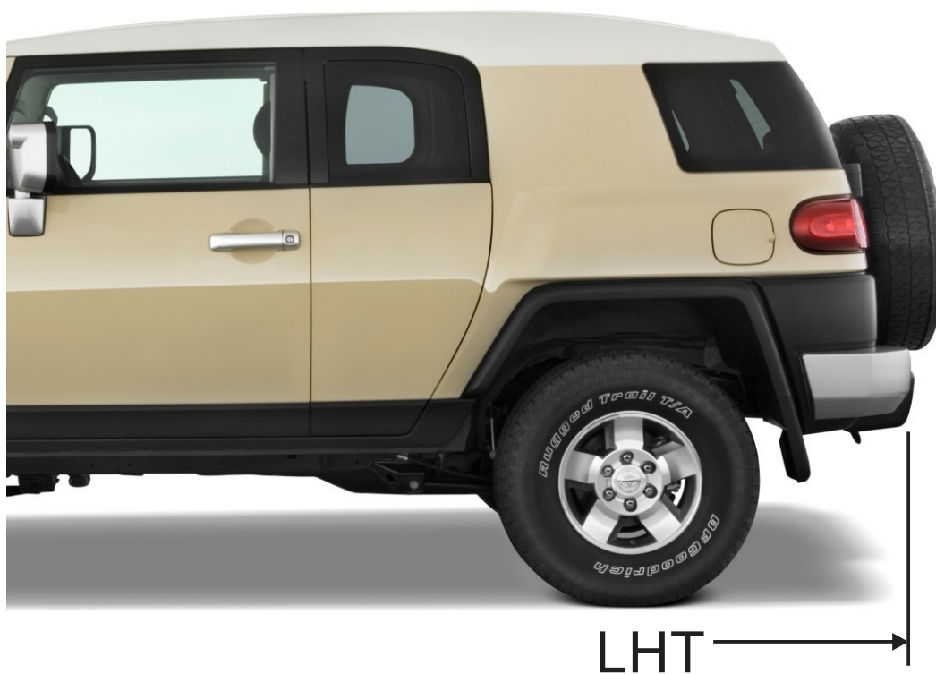
Figure 7 – La longueur hors tout exclut la roue de secours montée à l'arrière
