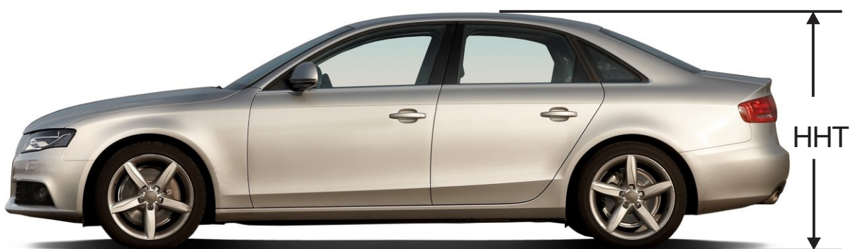
Figure 10 – Mesure de la hauteur hors tout
