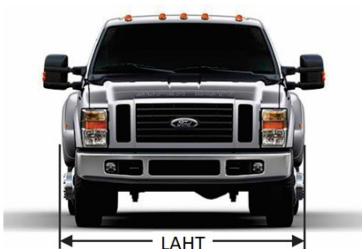
Figure 9 – La largeur hors tout inclut les élargisseurs d'ailes
