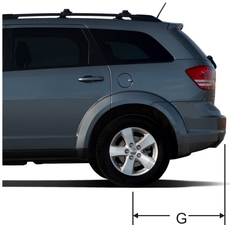
Figure 29 – Mesure du porte-à-faux arrière
