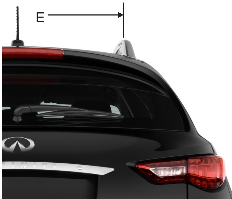
Figure 26 – Mesure de la largeur de toit (décapotables)
