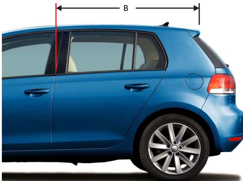
Figure 17 – Mesure de la longueur de l'extrémité arrière (voitures à hayon, familiales, fourgonnettes et VUS)
