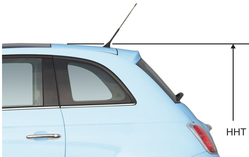
Figure 11 – La hauteur hors tout exclut les antennes et les options
