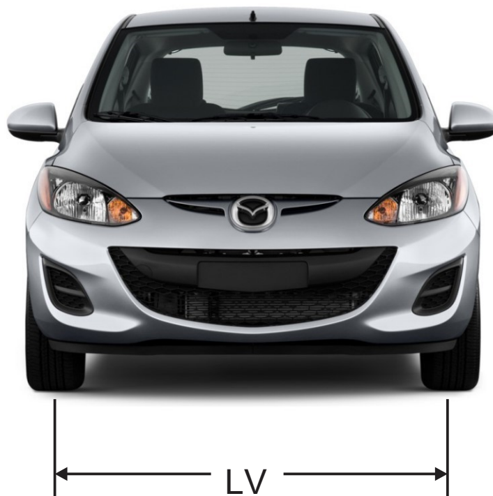
Figure 31 – Mesure de la largeur de voie
