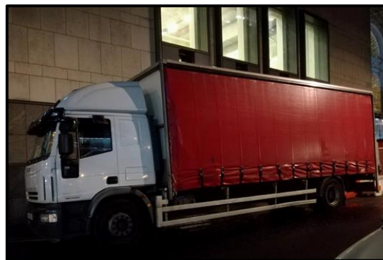
Figure 1 : Protections latérales installées sur un camion porteur (Londres, Grande-Bretagne) Photographie : Morgane SICILIA, 2017
